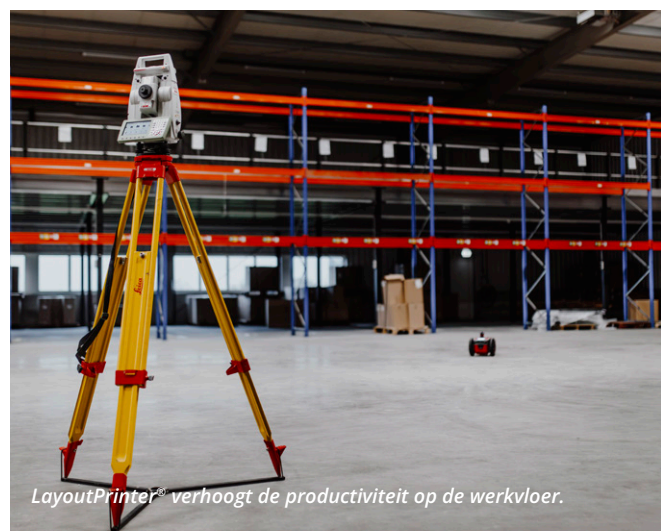
Print bouwtekeningen (lijnen, vormen, teksten en symbolen) direct op de werkvloer.
